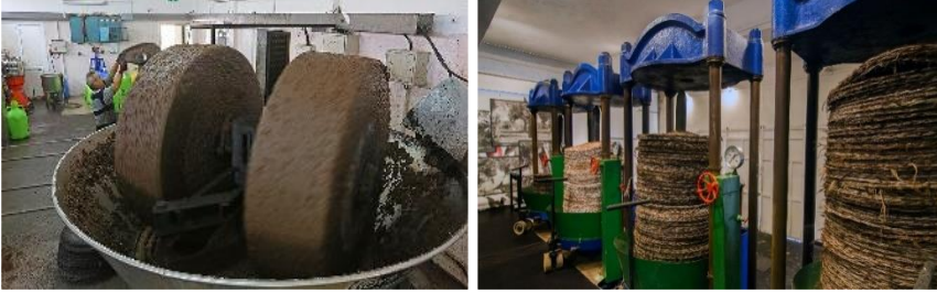
Εικόνα 58. Φωτογραφίες παραγωγής ελαιόλαδου σε σύστημα παρτίδας (με πρέσα) (Dawson, 2020; Orfion, 2017)
