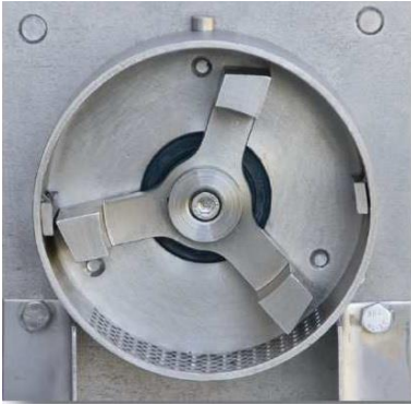
Σχήμα 64. Εσωτερική όψη του ελαιοθραυστήρα
