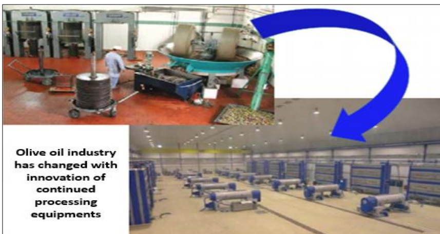
Εικόνα 59. Εγκατάσταση παραγωγής ελαιολάδου που λειτουργεί σε παρτίδες και συνεχές σύστημα (τροποποιημένο από Clodoveo & Amirante, 2017)
