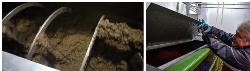
Εικόνα 66. Εσωτερική όψη του μαλακτήρα και μέτρηση θερμοκρασίας (σύστημα παρτίδας)
