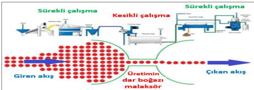
Şekil 68. Zeytinyağı üretiminde malaksörün neden olduğu dar boğaz (Clodoveo, 2015)
