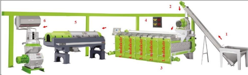
(1: ayıklanmış, yaprağı uzaklaştırılmış ve yıkanmış zeytinlerin besleme haznesi, 2: kırıcı, 3: malaksörler, 4: malaksör sıcaklık göstergesi, 5: dekantör, 6: separatör)
