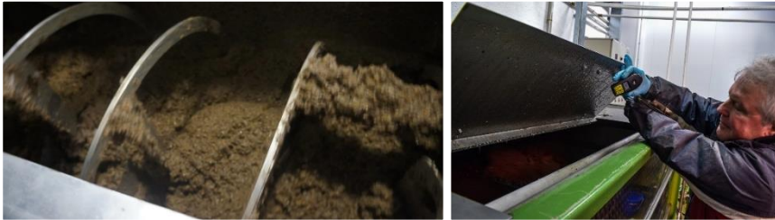
Şekil 66. Malaksörün iç görünümü ve sıcaklık ölçümü
